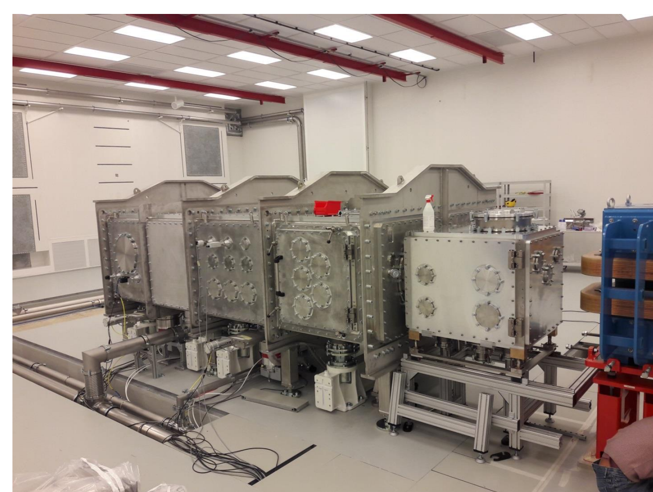
Obrázek 7: Pracovní stanice pro generování částicových svazků pomocí vysokoenergetických laserů.
